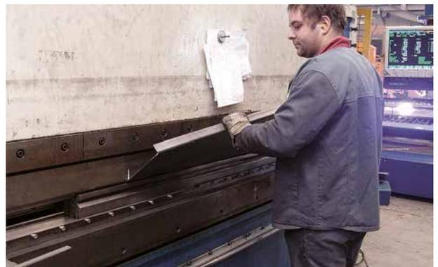
*Stufenherstellung an Hochleistungs-Abkantpresse*
